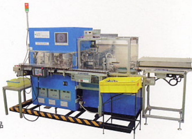
静電気を利用して、微細・微小バリを検知し品質保証を可能にする SIVシステム装置
