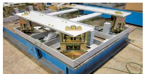
▲高精度特定計量器の内部構造
