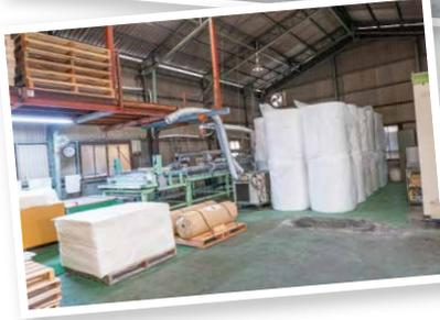
つくる製品に合わせて取引先の工場で配合した粘着剤を、自社工場ですべてのフィルムに塗布することで製品として仕上げる。
