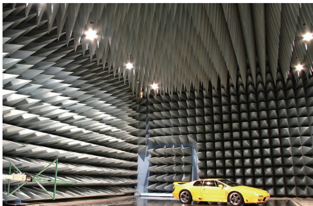
大型電波暗室
