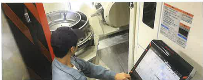
立形複合加工機での航空機エンジン部品の5軸加工
