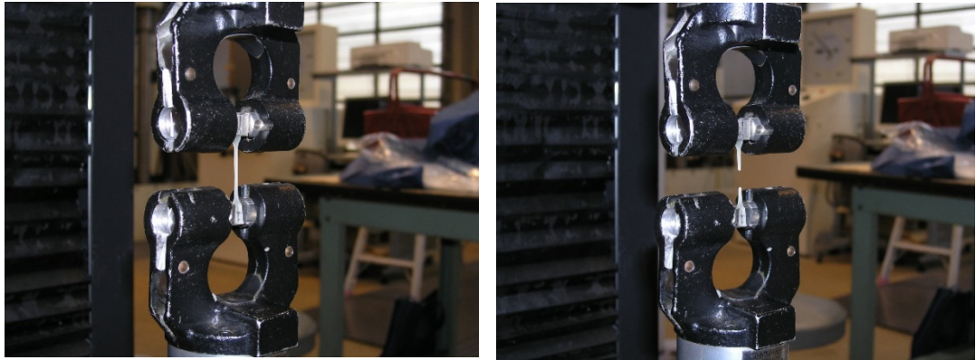
図6 引張強度試験の状況（左：破断前，右：破断後）
