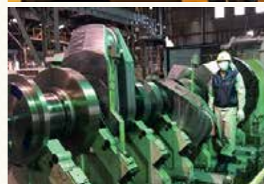
独自技術を投入して開発・導入したクランクシャフト専用加工機
