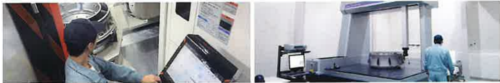
立形複合加工機での航空機エンジン部品の5軸加工 大型CNC三次元測定機(高速5軸ヘッド搭載)による測定
