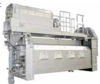
ハイブリッド型圧入式スクリュースプレ脱脱水機 (ISGKV型)
