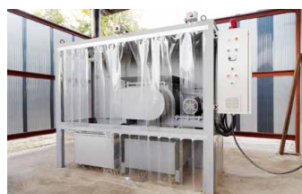
凍結・破碎を行い回収するドライ方式プラント。従来の方法より環境負荷が少ない方法で効率的に回収できるという
