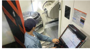
立形複合加工機での航空機エンジン部品の5軸加工
